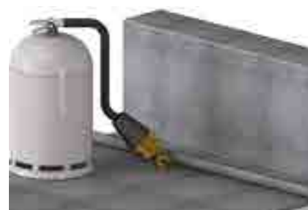
3. Překrýt první vrstvu svislého asfaltového podkladního pásu
