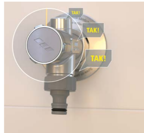
Nadměrnému utahení za bod zavření zabraňuje ochrana proti přetočení v mechanismu rukojeti. Komponenty jsou tak chráněny před poškozením v důsledku nadměrně silného zavření.
