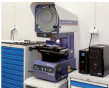
Profilový projektor. Laboratoř oddělení kvality.
