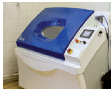
Korozní komora pro simulaci extrémních podmínek a testování materiálů.
