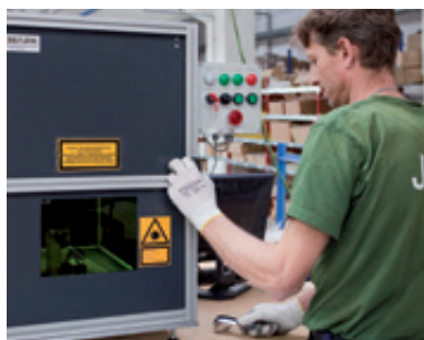
Laser při procesu vypalování loga.
