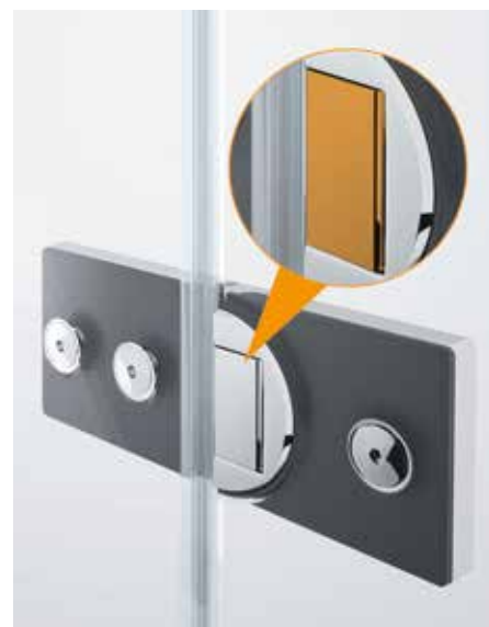
Zvedací/spouštěcí mechanismus – decentně schovaný za krytkou – zvedá snadno dveře při otevření. Tím šetří spodní těsnicí lišty a zajišťuje téměř automatické zavírání dveří.
